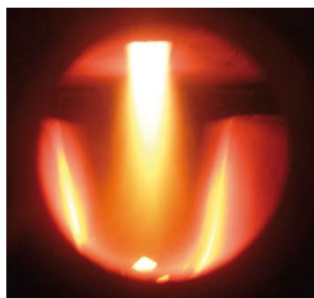
Technika zgazowywania w kotle Vitoligno 100-S
